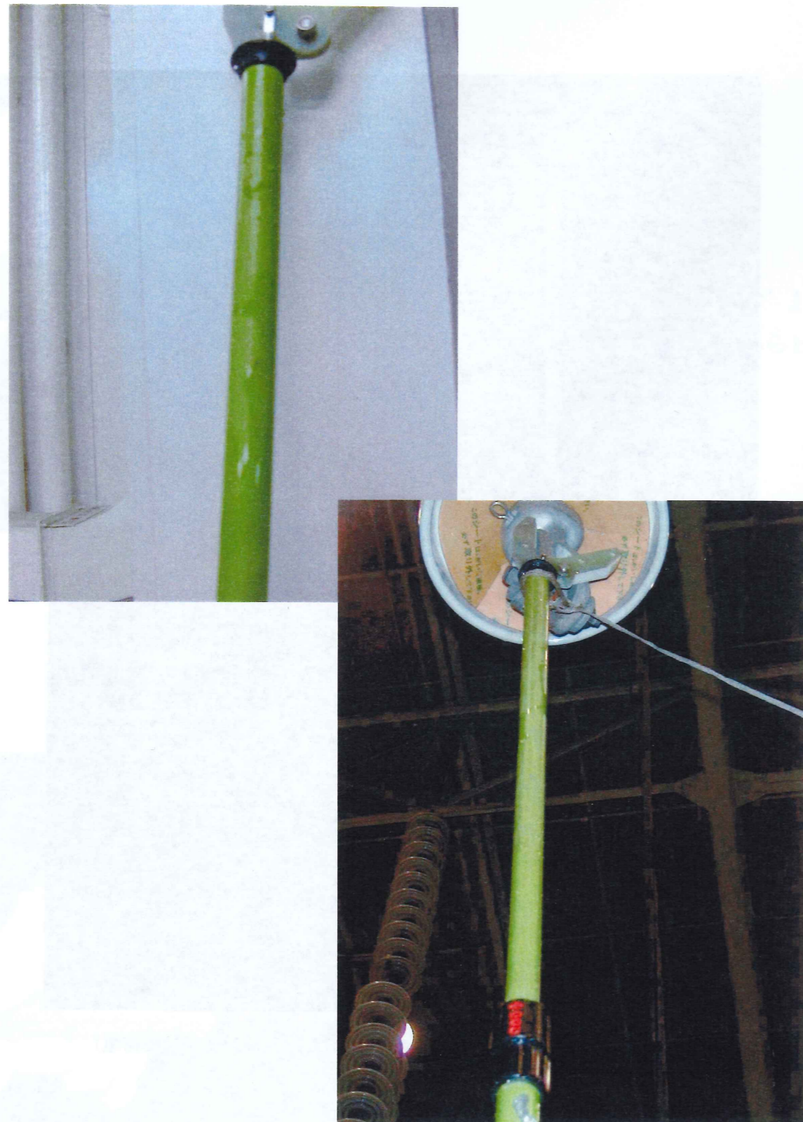
図2 営巣材除去器具を浸水後試験
