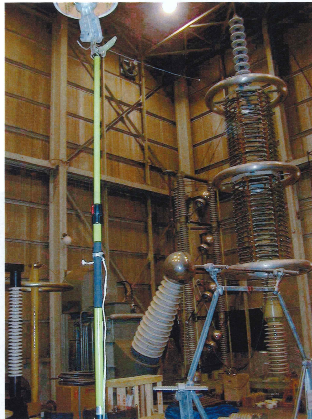
図1 営巣材除去器具の耐圧試験状況（275kV試験用変圧器で荷電）
