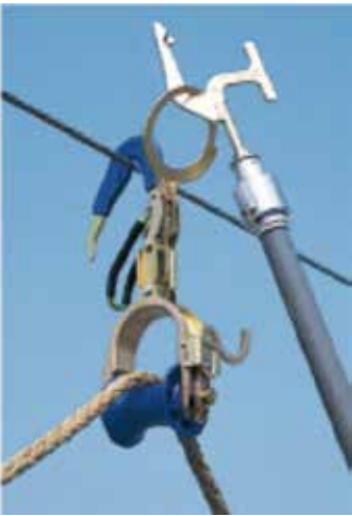
つり線への取り付け状態
